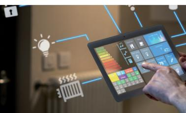
L'installation d'un système de télégestion permet de programmer les températures et d'adapter le fonctionnement du chauffage à distance et selon l'occupation des bâtiments.
